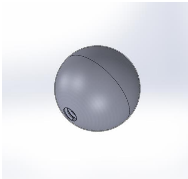
Рисунок 68 – Схематичное изображение световозвращающей сферы
